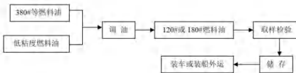
图 4.3 油品调和工艺流程图
