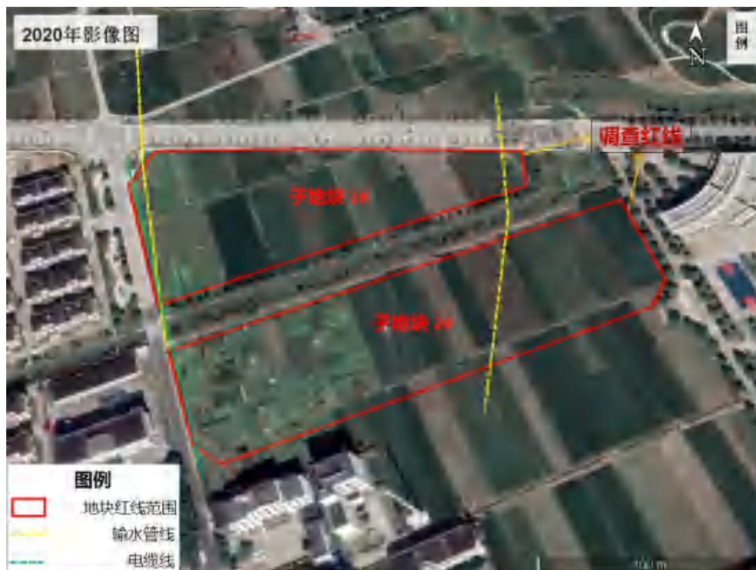
图 3.7 地块平面布置及地下管线图
