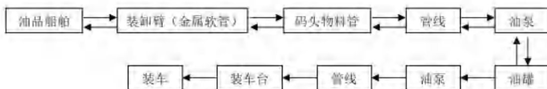
图 4.2 油品装卸工艺流程图
